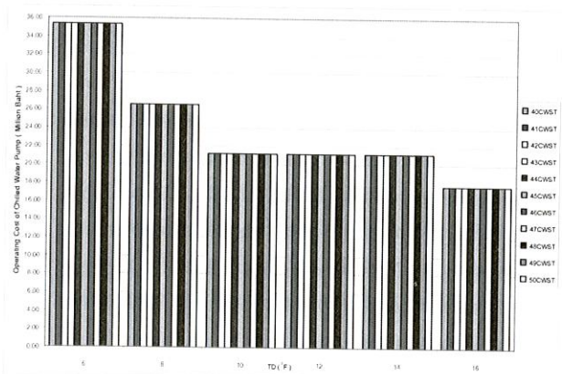
รูปที่ 10 แสดง OC PUMP เมื่อ 40°F ≤ CWST ≤ 50°F และ 6°F ≤ TD ≤ 16°F
